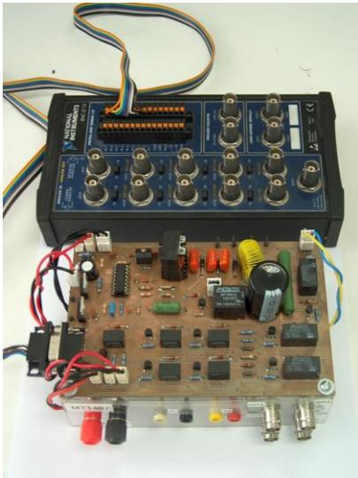
Fig. 1 Interface Analógica/Digital (acima) e Circuito compacto de ensaio (abaixo)
