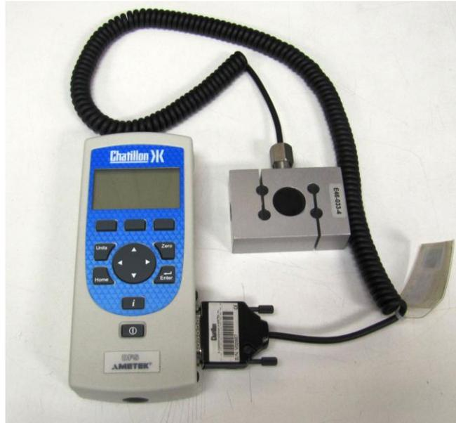
Figura 47 - Dinamômetro e célula de carga Chatillon
