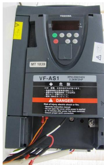
Figura 40 - Inversor de frequência Toshiba.
