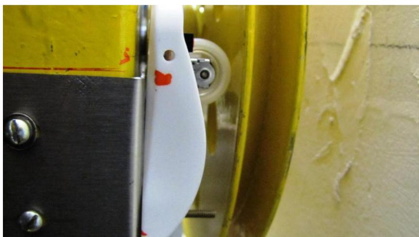
Figura 43 - Botão de rolagem fixado a estrutura do motor
