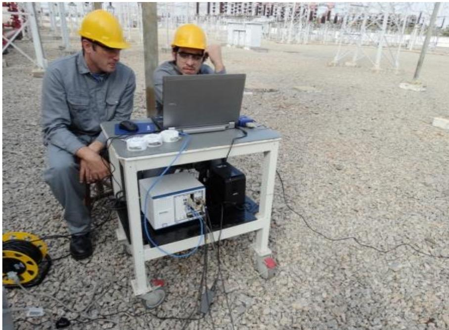
Figura 4 - Módulo de Supervisão Local (MSL): Utilização do MSL em campo, em Subestação CTEEP Oeste.
