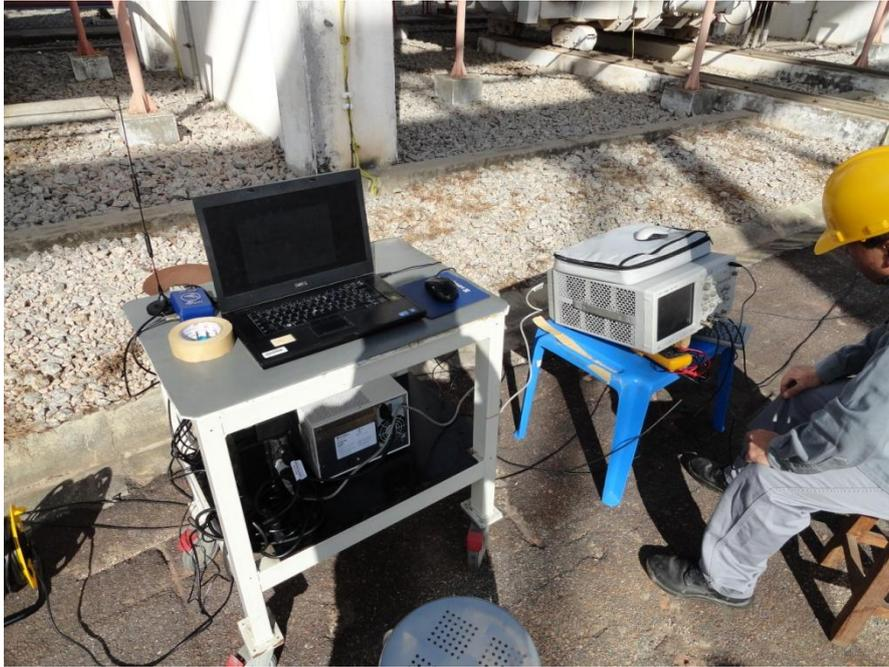
Figura 5 - Módulo de Supervisão Local (MSL): Validação do MSL em campo, comparada com método convencional utilizando-se osciloscópio e pós-processamento de dados, em Subestação CTEEP Oeste.
