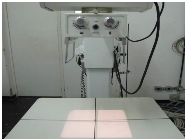
Figura 5 – Quadrante de luz produzido pelo colimador
